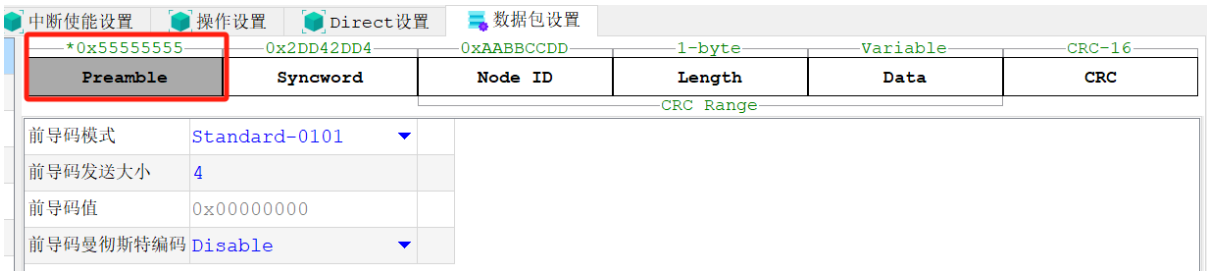
图 24: 数据包设置之前导码字段
