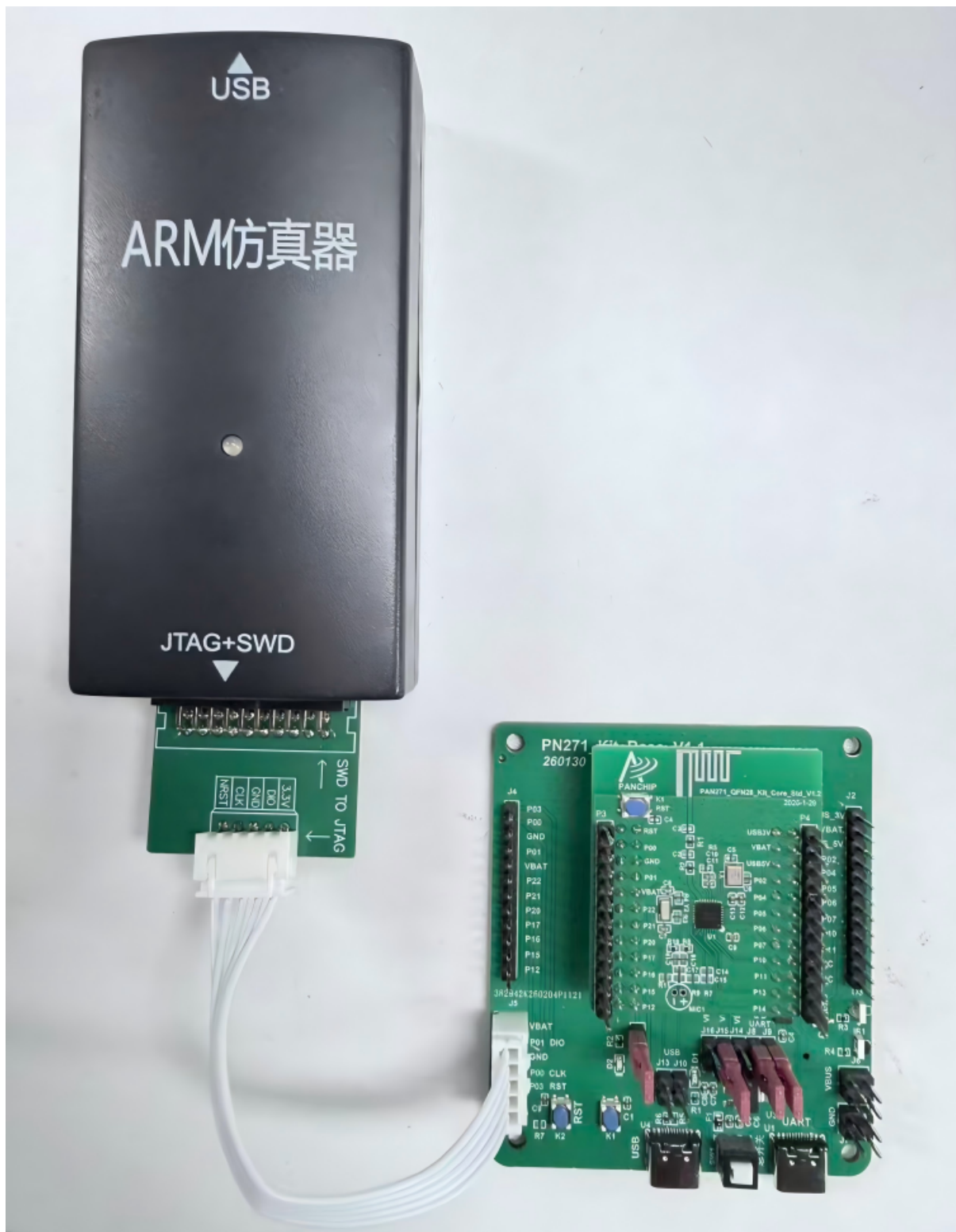
图 7: JLink 接线示意图
