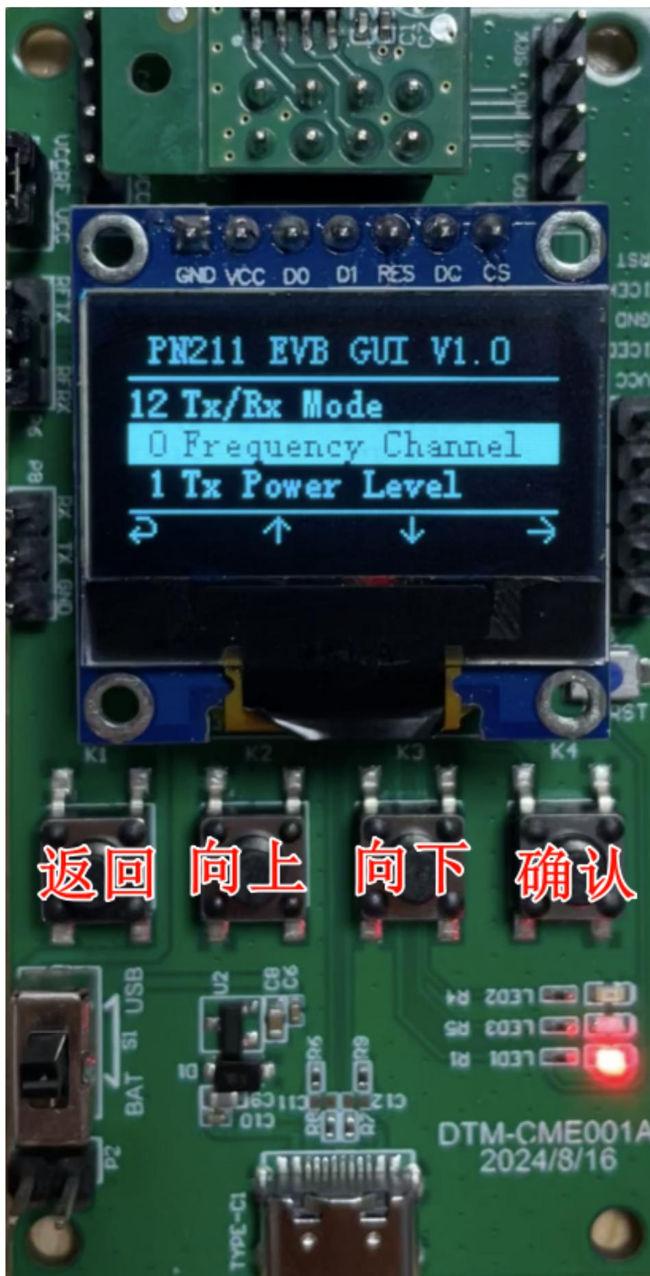
参数设置界面中，可以设置参数具体的值。K1 为返回键，K2 为上翻键，K3 为下翻键，K4 为确认键。按下返回键后，可以返回到参数设置界面。按下上下翻键可以切换参数，按下确认键同样返回到参数选择界面。
