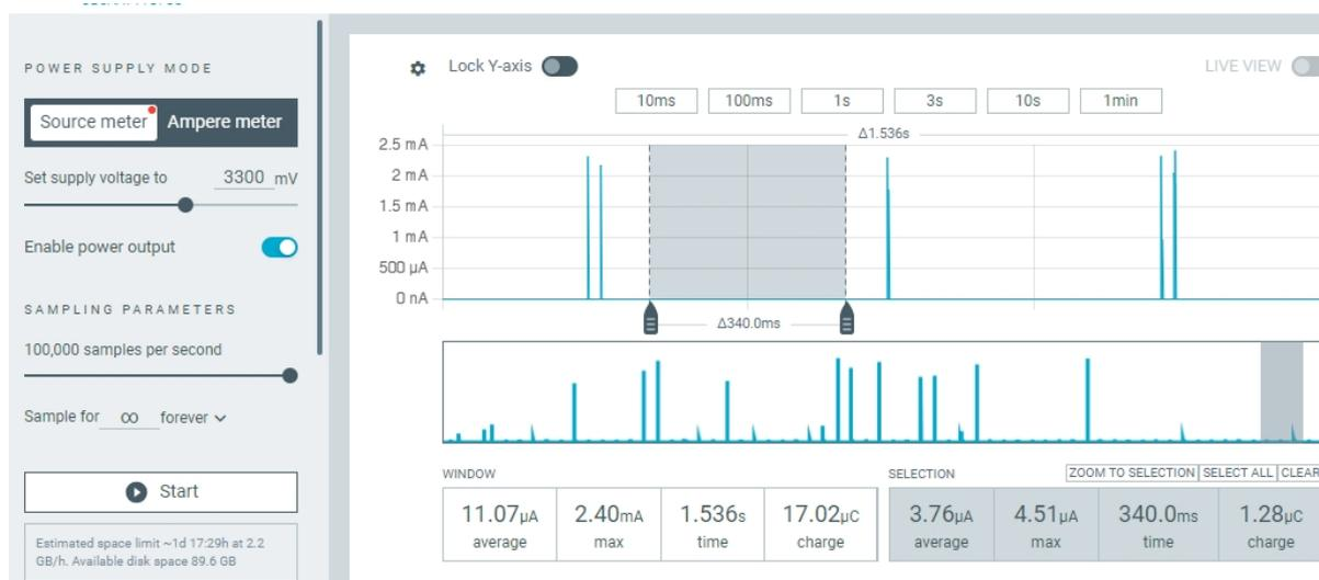
图 22: 使用电流计抓取电流波形
