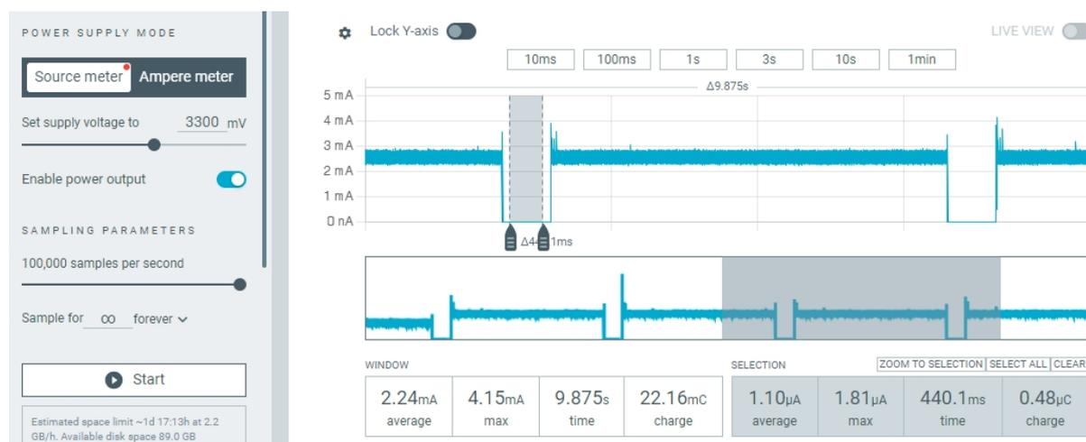
图 30: 使用电流计抓取电流波形
