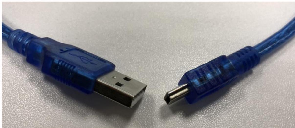
图 2: 图 2-1-2 MiniUSB 连接线
