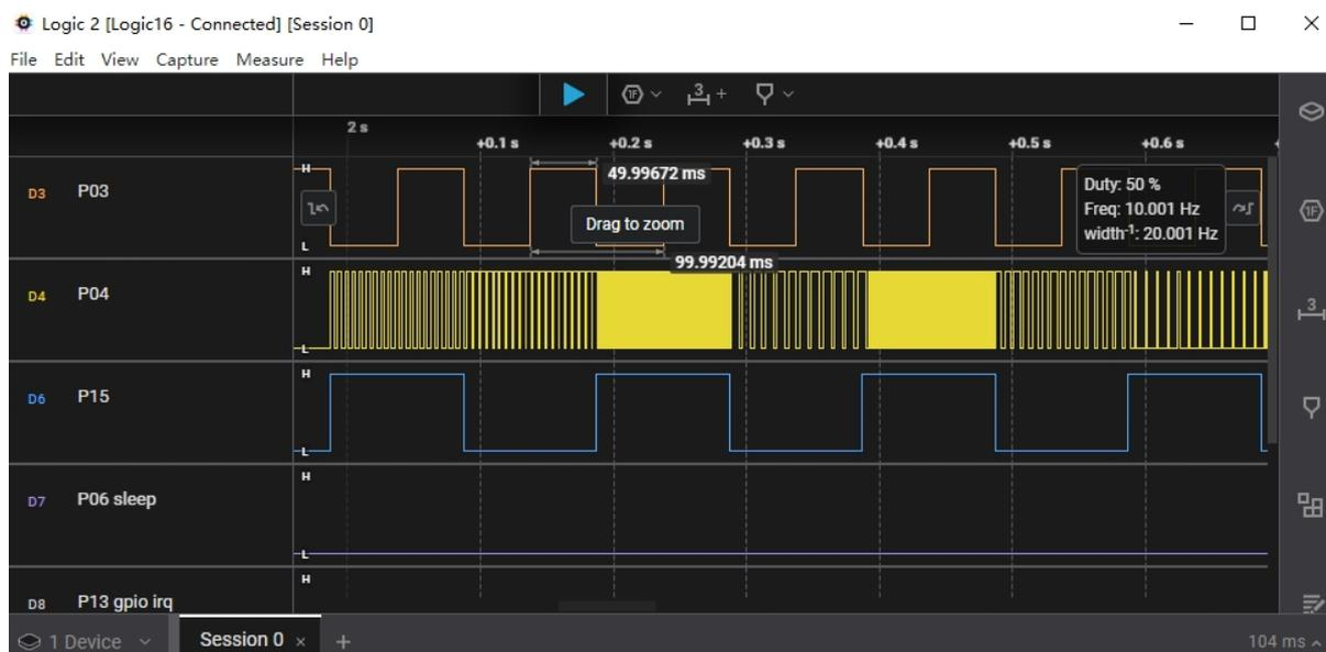
图 24: 使用逻辑分析仪抓取 PWM 输出波形
