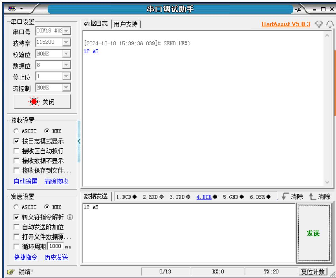
4. 观察 UART Log, 可以看到成功触发 UART 中断将芯片唤醒, 并打印接收到的串口数据:
