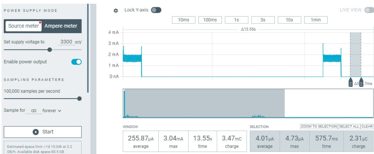
图 36: 通过 UART1 Rx IO (P07) 的 GPIO 方式将系统唤醒, 之后重新进入 DeepSleep 状态
