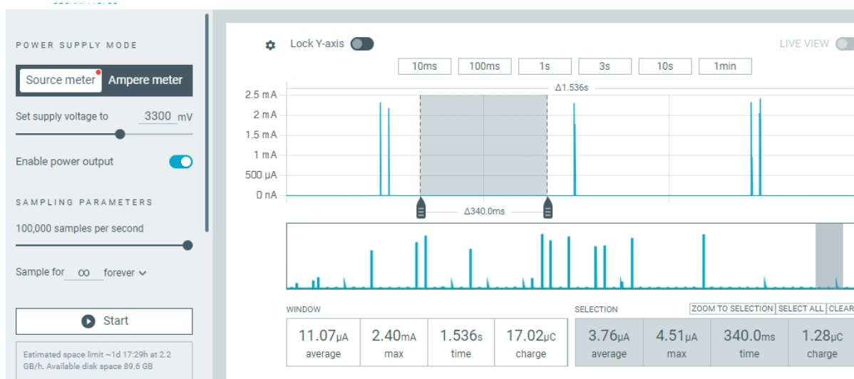
图 22: 使用电流计抓取电流波形
