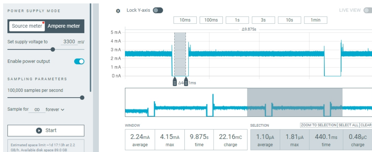
图 30: 使用电流计抓取电流波形
