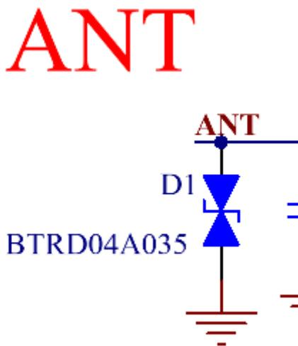
图 39: 天线端静电防护示意图
