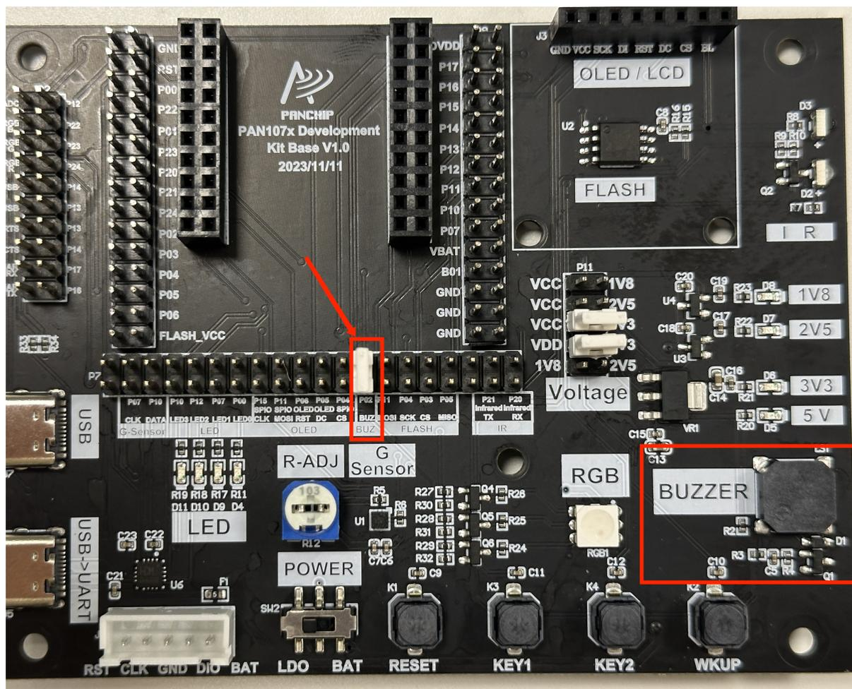
图 25: 蜂鸣器模块实物接线图
