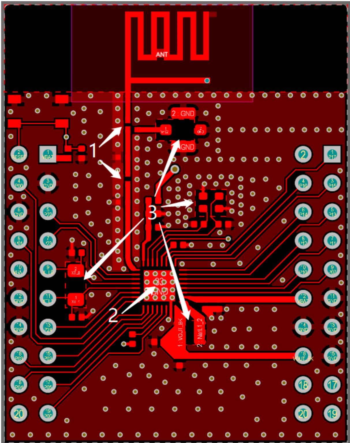
图 47: PAN1070UA1A 射频链路走线示意图
