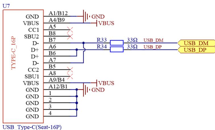
图 16: USB 模块外围电路原理图
