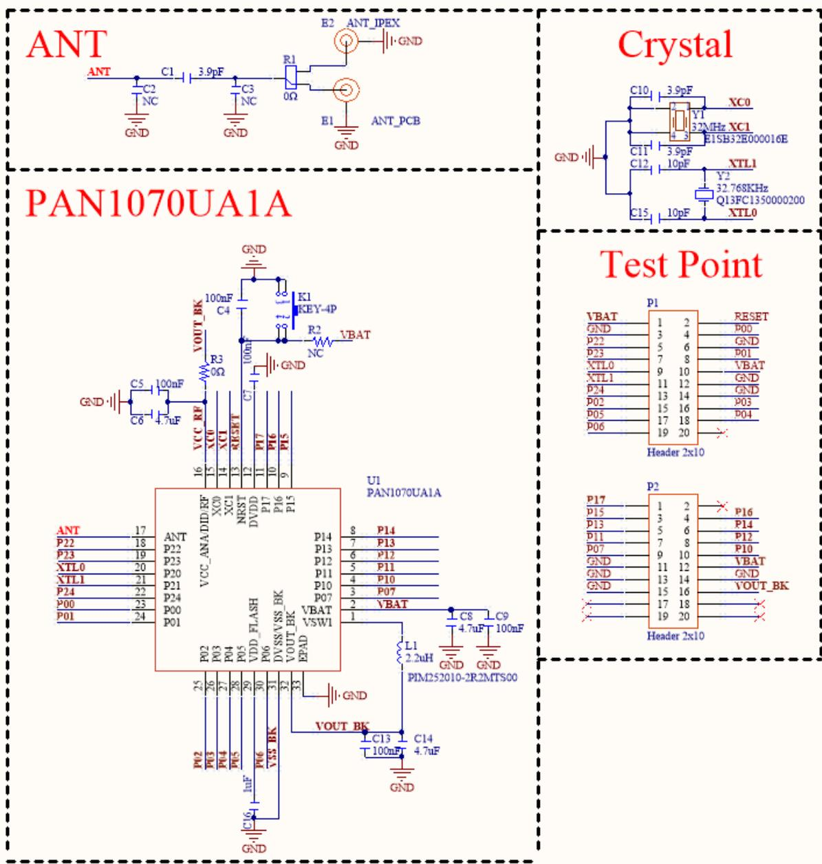
图 35: PAN1070UA1A 最小系统参考设计原理图
