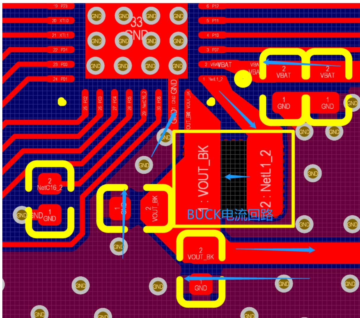
图 45: PAN1070UA1A DC-DC Layout 示意图
