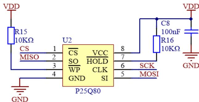
图 22: 外部 SPI Flash 模块原理图
