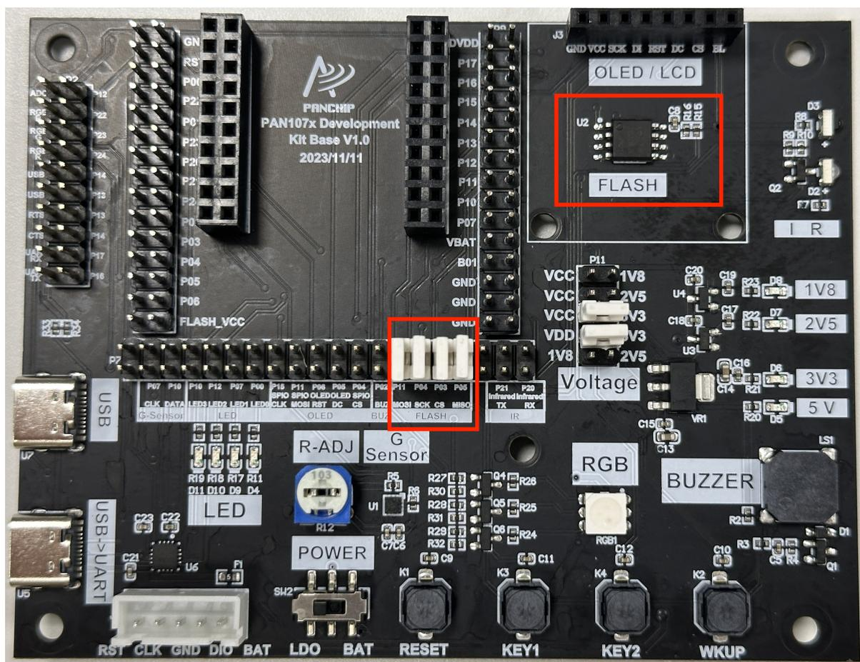
图 23: 外部 SPI Flash 模块实物接线图
