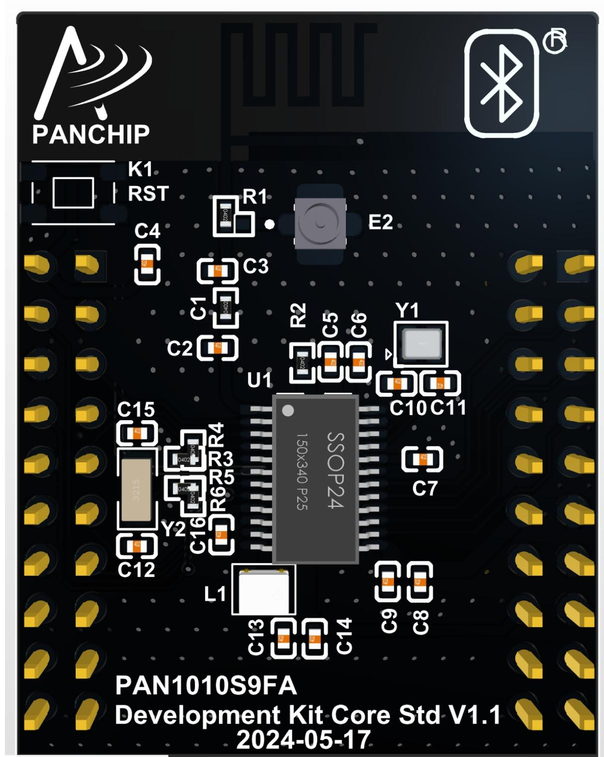
图 3: PAN1010S9FA 最小系统板三维图顶部
