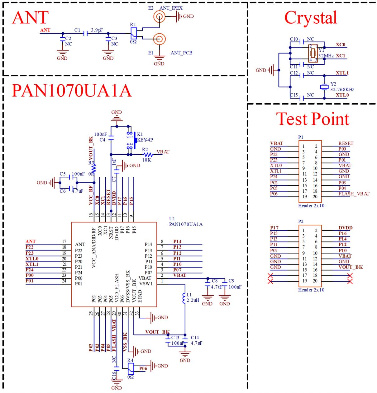
图 8: QFN32 封装核心板原理图
