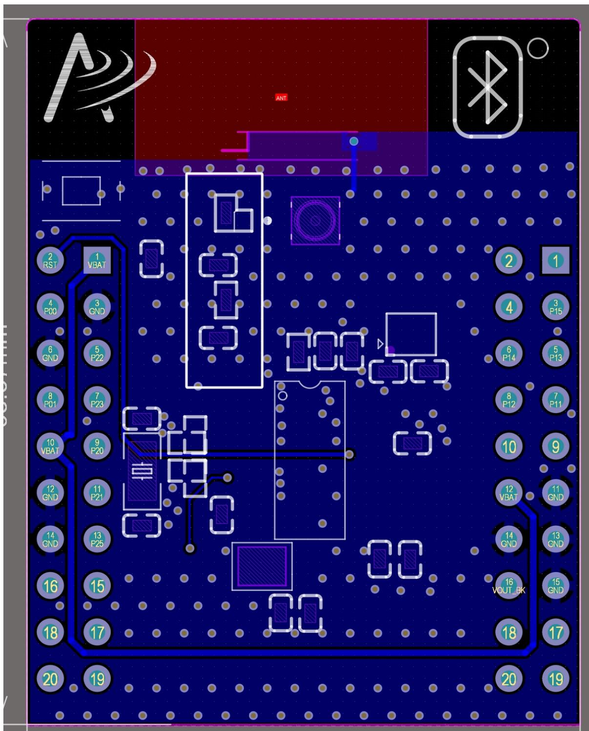
图 48: PAN1010S9FA 射频地线走线示意图
