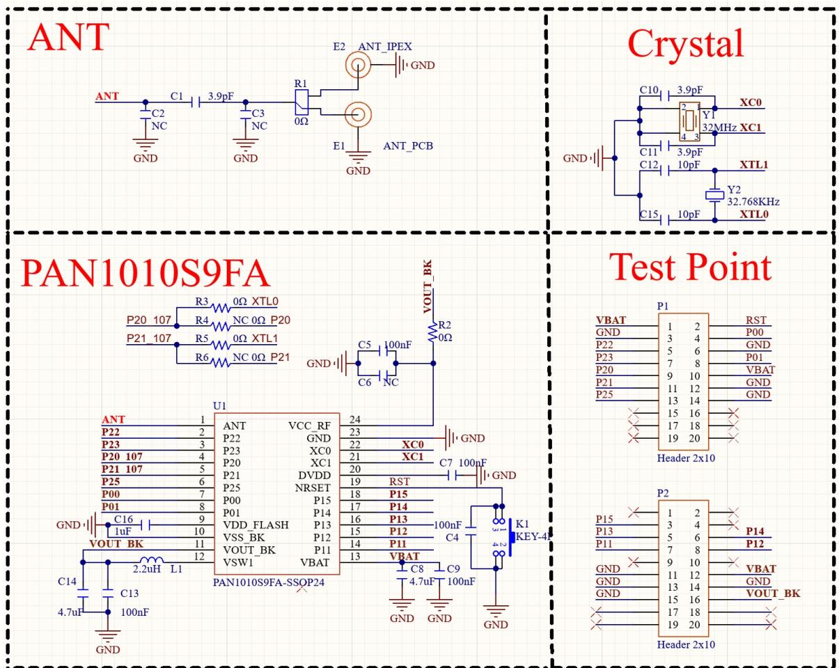
图 34: PAN1010S9FA 最小系统参考设计原理图
