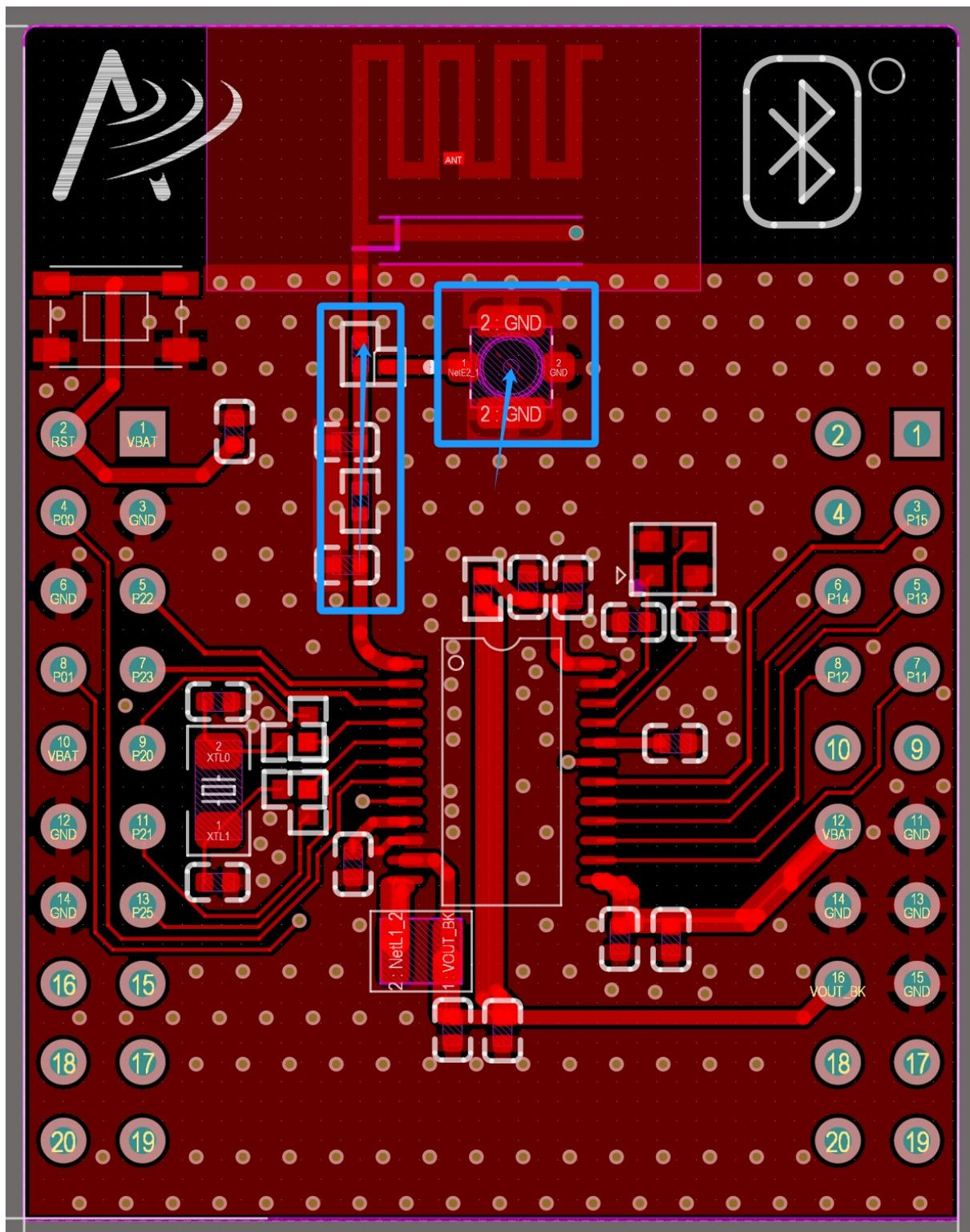
图 46: PAN1010S9FA 射频链路走线示意图
