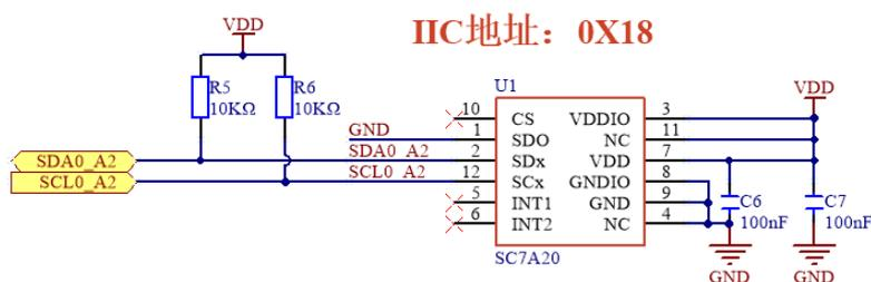
图 18: G-Sensor 模块原理图
