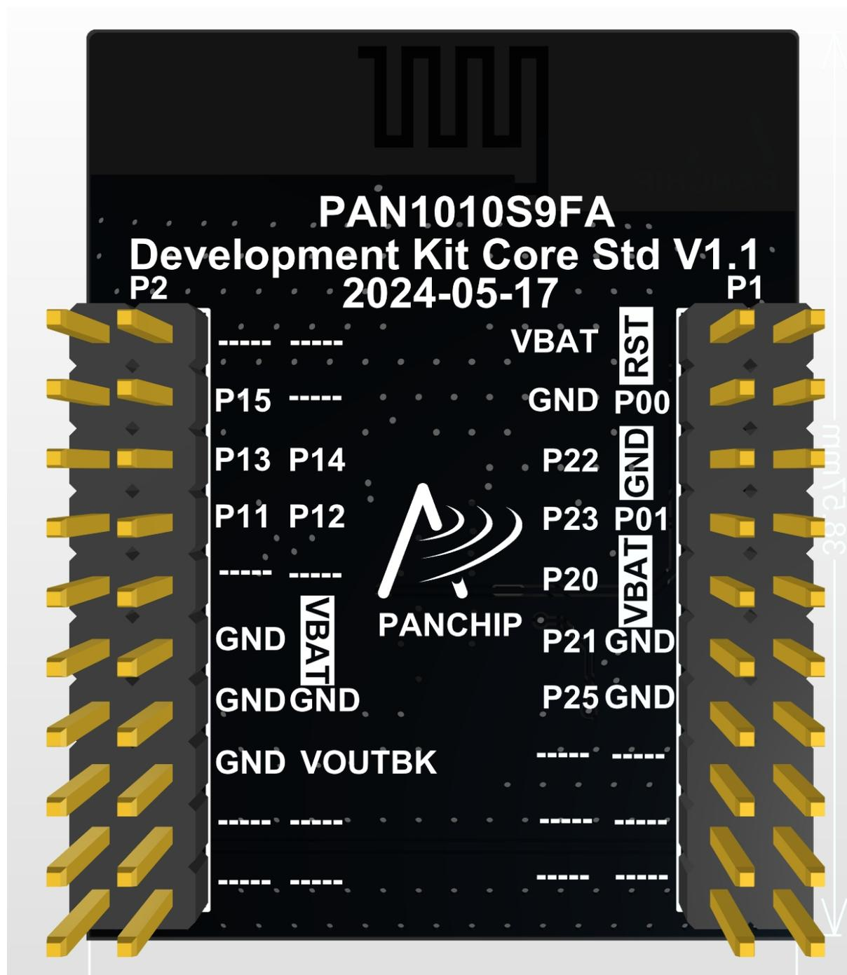
图 5: PAN1010S9FA 最小系统板三维图底部
