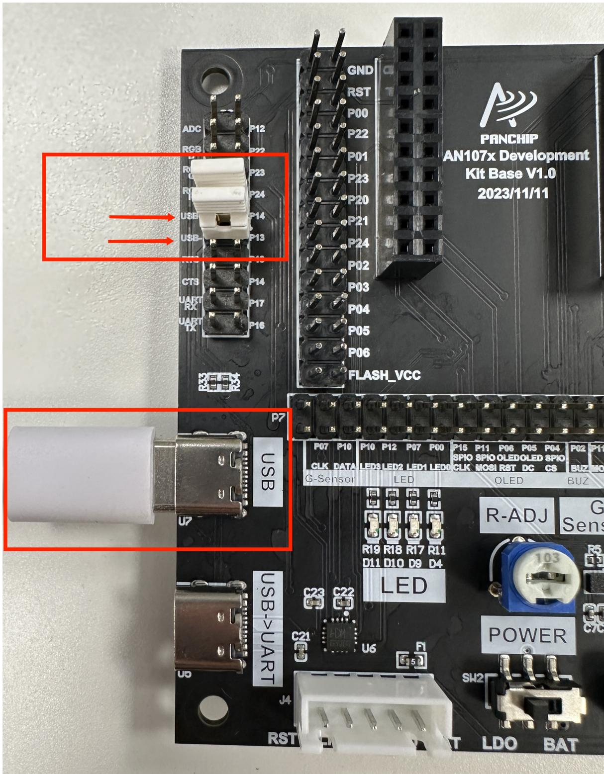
图 17: USB 模块外围电路实物图
