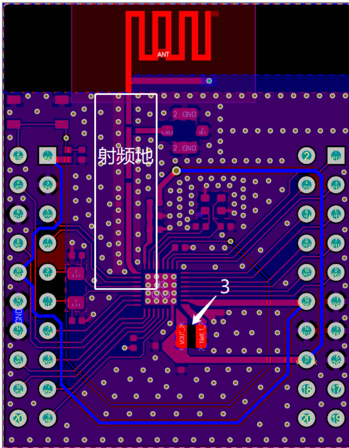
图 49: PAN1070UA1A 射频地线走线示意图
