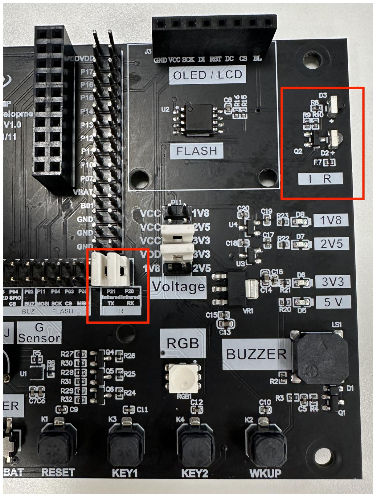
图 33: 红外模块实物接线图
