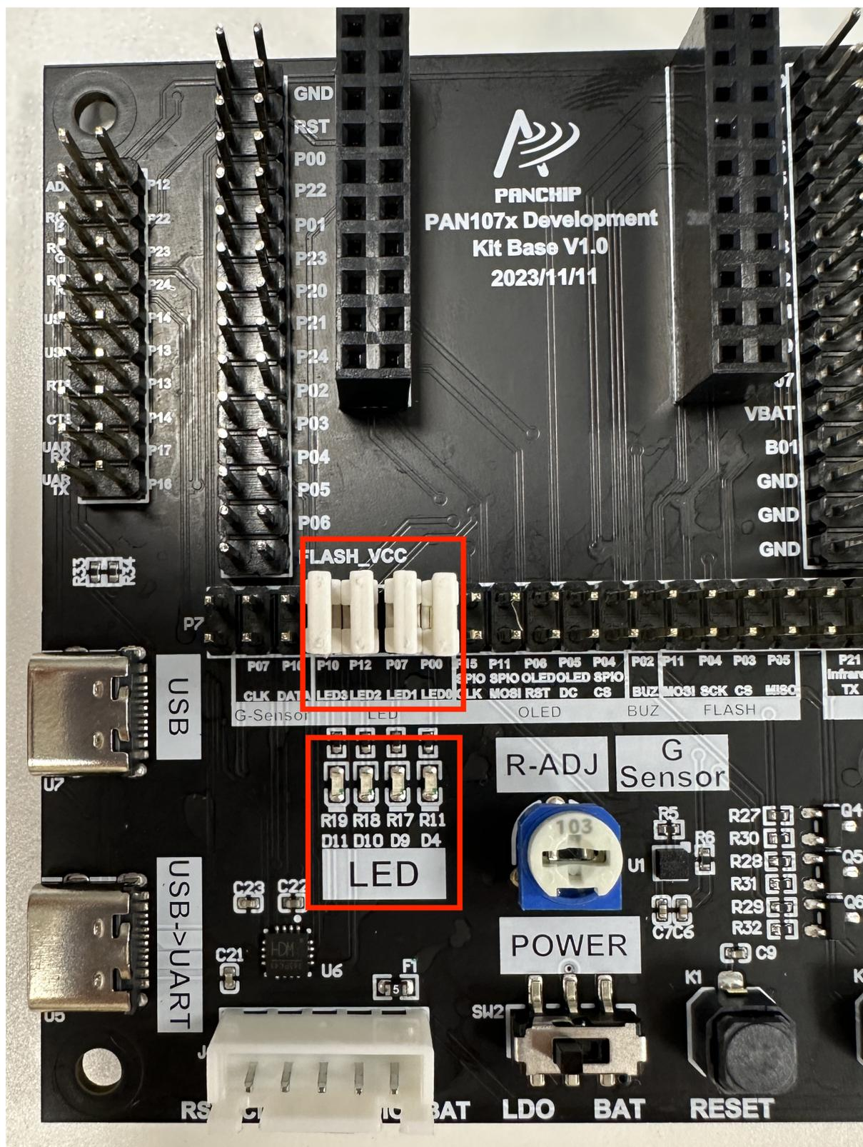
图 31: LED 灯模块实物接线图
