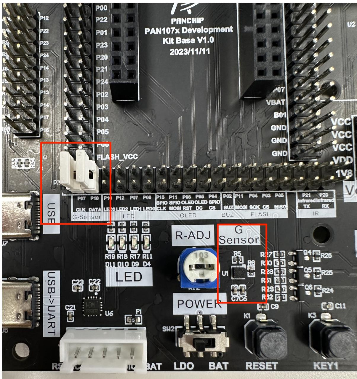
图 19: G-Sensor 模块实物接线图
