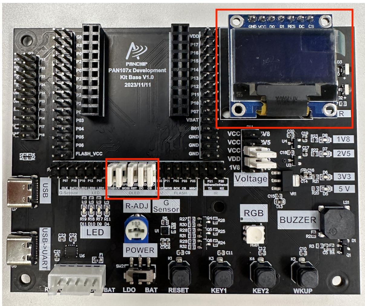
图 21: OLED 模块接线实物图
