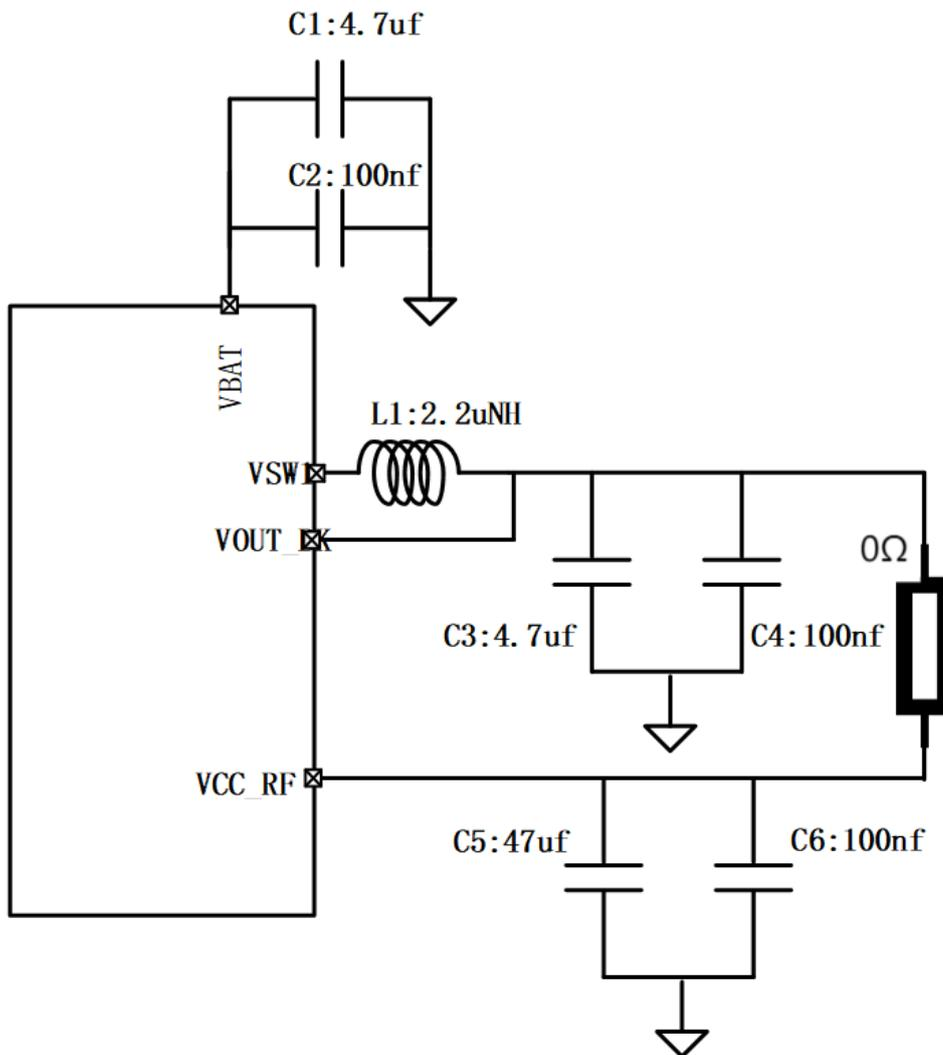
图 43: DC-DC 外围电路
