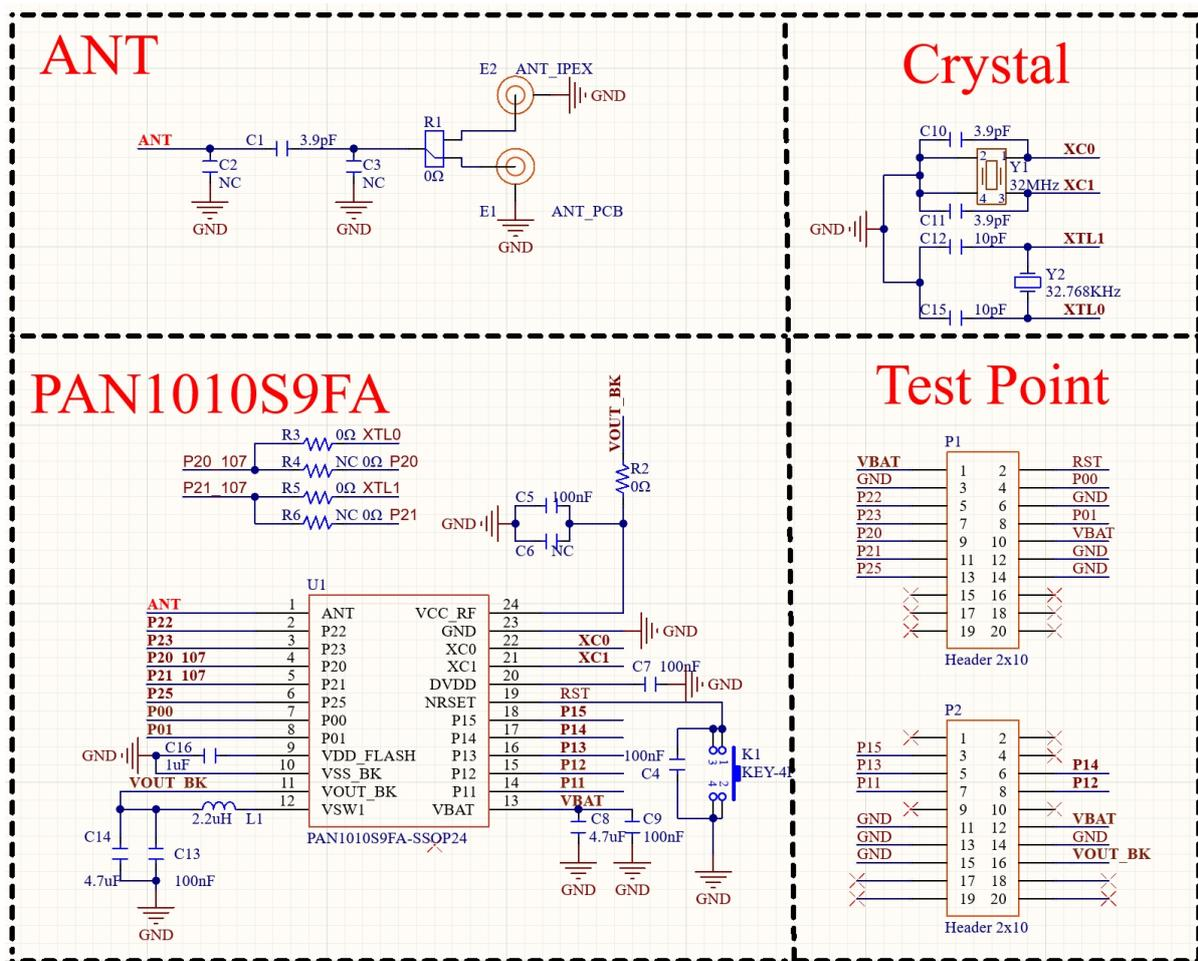
图 7: SSOP24 封装核心板原理图
