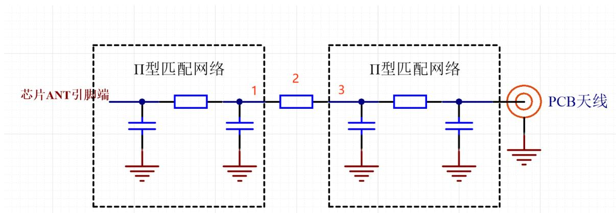
图 52: RF 网络匹配原理示意图
