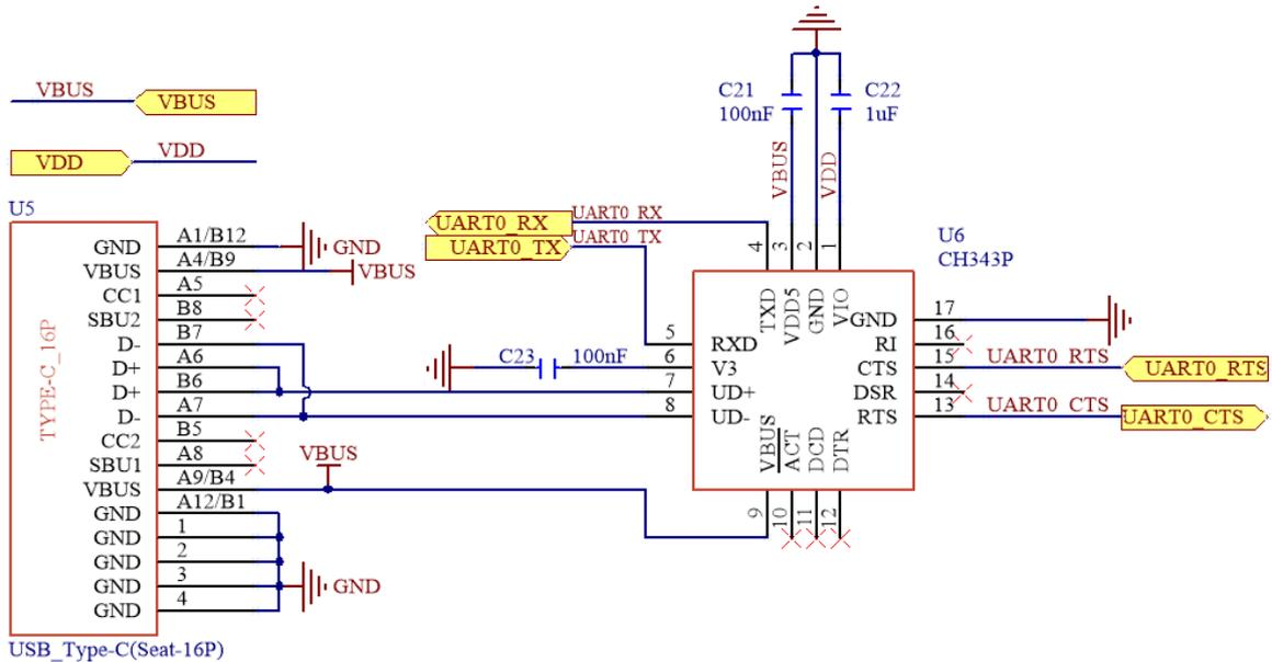
图 12: USB 转 UART 模块原理图
