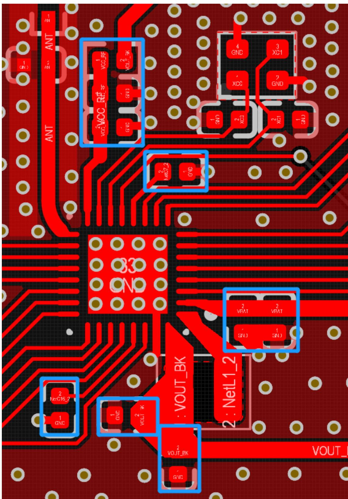
图 42: PAN1070UA1A 电源去耦电容布局
