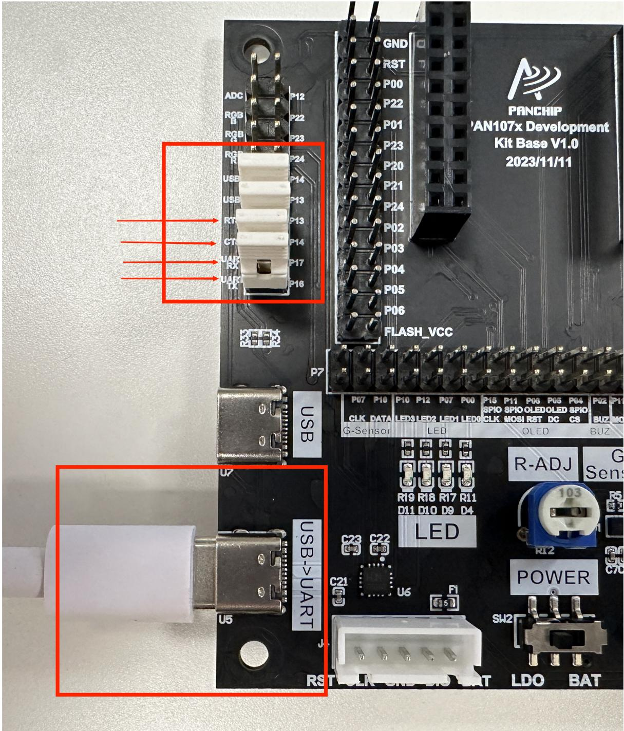
图 13: USB 转 UART 模块实物接线图
