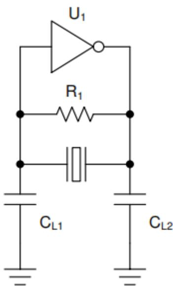
图 36: 32MHz 晶振外围电路示意图
