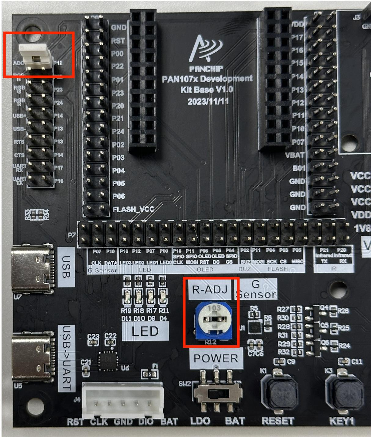
图 27: ADC 模块示例接线图
