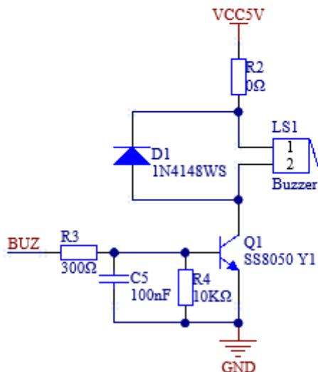
图 24: 蜂鸣器模块原理图
