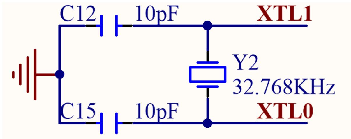
图 37: 32KHz 晶振外围电路原理图
